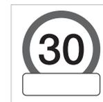
在駕駛人顯示器的速度符號<sup>88</sup>下以空白方框形式表示的額外標誌專用符號意味著此功能已偵測到額外標誌，而該標誌內含與目前速限有關的補充資訊。
