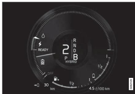
駕駛人顯示器顯示電動馬達煞車時的充電狀態。
