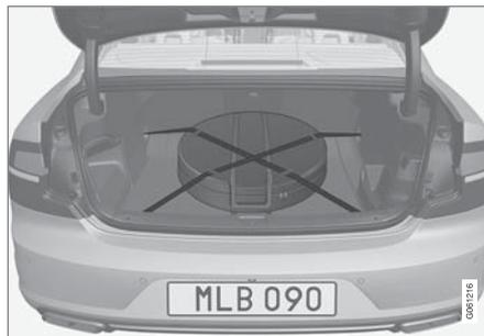
在行駛過程中，裝有備胎的收納袋必須以兩條固定帶栓妥於行李廂地板上。兩條固定帶必須順時針繞備胎拉緊，並固定在車輛的四個貨物固定孔眼中。
