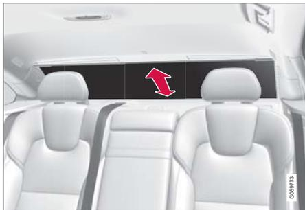
在後車窗擱板上裝置了電動操作的遮陽板。
