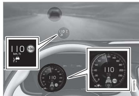
上圖<sup>50</sup>顯示 Pilot Assist 設定為保持 110 km/h (68 mph)，同時跟隨保持相同速度的前車。
