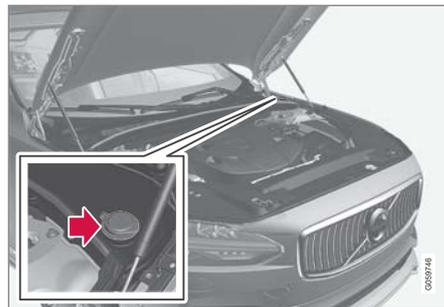
清洗液是填充進附有藍色蓋子的貯液筒中。此貯液筒為擋風玻璃沖洗器與頭燈沖洗器共用\*。
