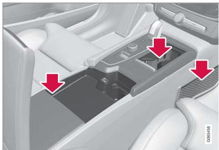
中央扶手控制台內包含杯座、電源插座、網袋\*及 USB 埠的儲物空間。
