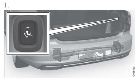
打開行李廂蓋。用以伸/縮拖車桿的按鈕位於行李廂後面右側。按鈕內的指示燈必須恆亮橘光，才可以啟動延伸功能。
