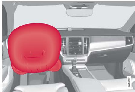
前座駕駛側的方向盤防護氣囊及膝部防護氣囊<sup>1</sup>。
