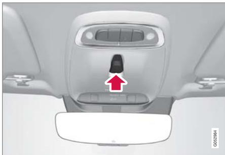
天窗是用位於車頂的一個控制器操控。當車輛的電氣系統位於點火開關位置 I 或 II 時，即可操作控制器。
