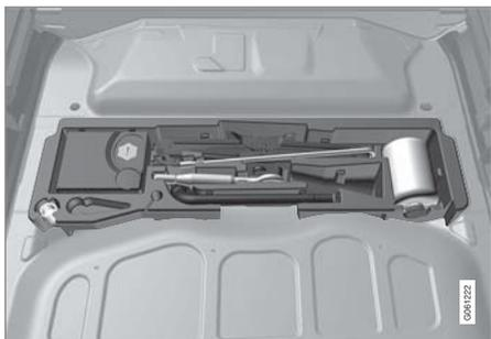
行李廂地板下的發泡磚容納車輛的拖鈎環、爆胎修理工具組、用來拆卸輪圈螺栓上塑膠蓋的工具以及可鎖輪圈螺栓的托座。
