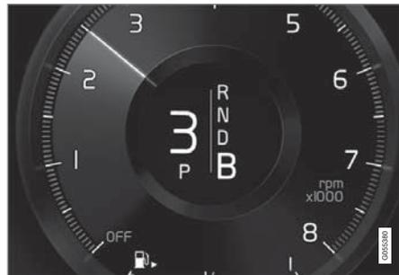
從 B 檔，可以手動降至低檔。在行駛期間，可以隨時選取 B 檔。汽車在放開油門踏板時利用電動馬達煞車，同時也為混合動力電池充電。如此有助於提高混合動力電池充電的機會，因為駕駛人不使用煞車踏板也會進行充電。
