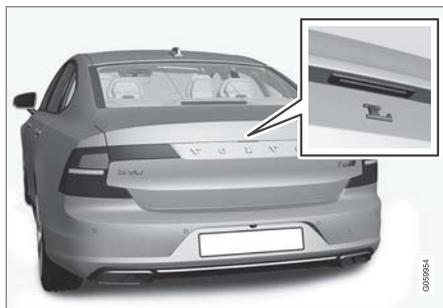
行李廂蓋上的橡膠壓板只能用於開鎖。
