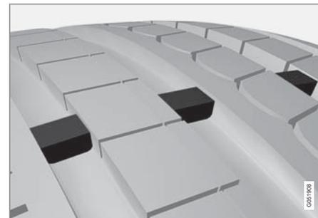
胎紋磨耗指示是一道跨越輪胎胎紋圖形縱向溝槽的凸起細線。輪胎側邊寫著字母 TWI (Tread Wear Indicator)。當輪胎胎紋深度磨耗到 1.6 公釐 (1/16 吋) 時，胎紋就會與胎紋磨耗指示齊平。此時應盡快更換新輪胎。請記住，當輪胎胎紋變淺時，其行駛於雨中與雪中的抓地力會相當差。
