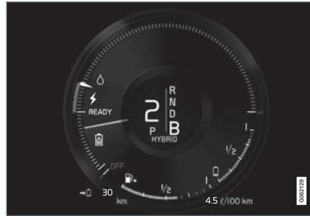
例如，當駕駛人輕微踩下煞車踏板或當下坡路段使用引擎煞車時，車輛產生的電力會供往電瓶，對電池充電。
