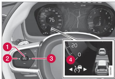
引擎發動後主動式定速巡航控制會處於待機模式。將之從啟用狀態設為待機模式的程序如下：
