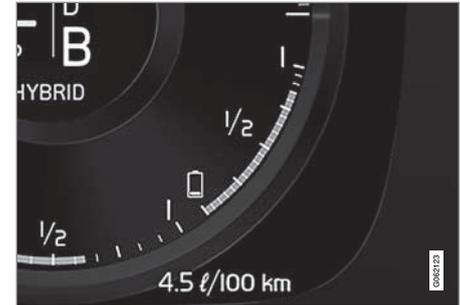
混合動力電池中的電力是供電動馬達使用，也用來冷卻和加熱車輛。旅程電腦計算混合動力電池中剩餘電力大約可行駛的距離。
