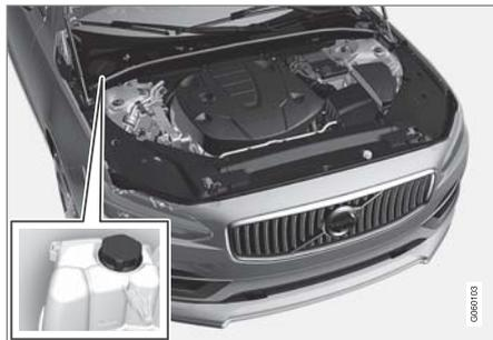
冷卻液膨脹水箱，左駕車。
