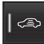
按下中央顯示器功能畫面中的已降低防盜按鈕，以後將車輛上鎖時便會關閉動作與傾斜偵測器。
