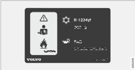
2 使用 R1234yf 冷媒車輛的空調系統資訊。
