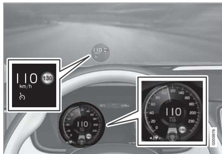
上圖<sup>50</sup>顯示 Pilot Assist 設定為保持 110 km/h (68 mph)，而且沒有前車可跟隨。
