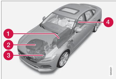
**1** 混合動力電池 - 混合動力電池的功能是儲存電力。其接收電力的方式是從電源電
