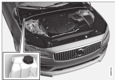
Tanque de expansão do fluido de arrefecimento, veículo com volante à esquerda.
