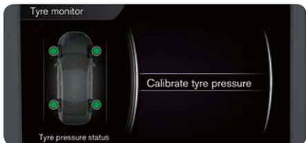
Dopo la sostituzione di pneumatici o modifica della pressione pneumatici è sempre necessario procedere alla taratura. L'accensione della spia (⚠) indica che è necessario tarare il sistema. Procedere come segue:
