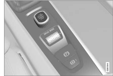
Tünel konsolundaki çalıştırma düğmesi.
