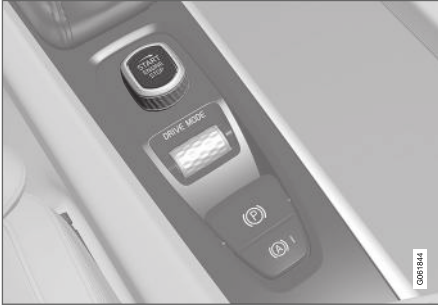
Tünel konsolundaki çalıştırma düğmesi.
