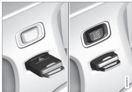
Tændingslås med fjernbetjening skubbet ud/trykket ind.
