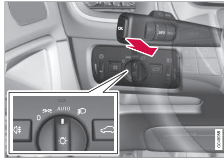
Kontaktarm og lyspanelets knap i position AUTO .
