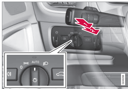
Kontaktarm og lyspanelets knap.
