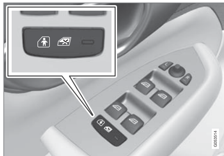
電動作動および解除用ボタン
