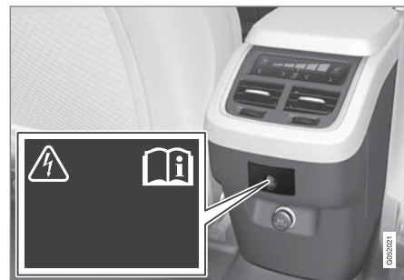
トンネルコンソールの電源ソケット (2 列目シート)
