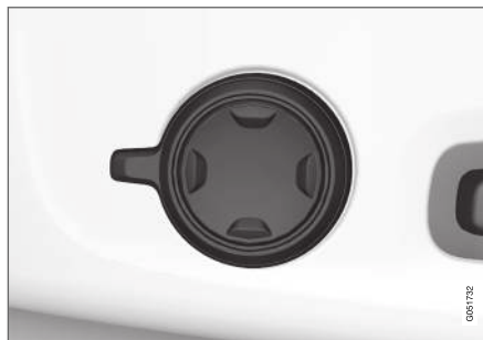
Multifunksjonsbryteren, i biler med 4-veis korsryggstøtte*.
