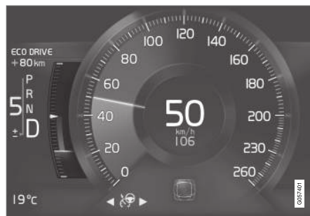
Eco-måleren i 8-tommers førerdisplay.
