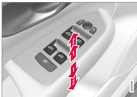
Regulering av vindusheiser.
