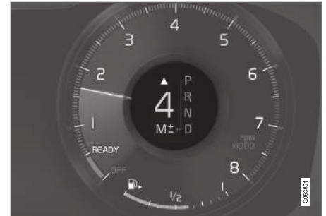
Girindikator på 12-tommers førerdisplay*.
