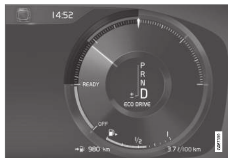
Eco-måleren på 12-tommers førerdisplay*.
