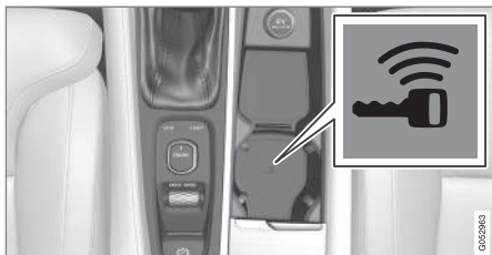
Backup-låsarens placering i tunnelkonsolen.
