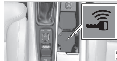
Backup-läsarens placering i tunnelkonsolen.
