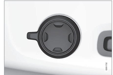
Multifunktionsreglaget, placerad på sidan av sätets sitt-del.
