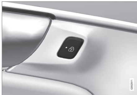
Låsknapp med indikeringslampa i baktörr.
