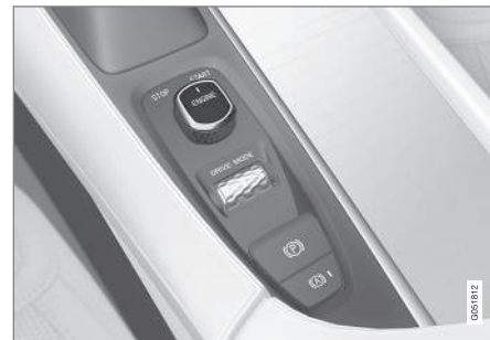
Startvredet i tunnelkonsolen.
