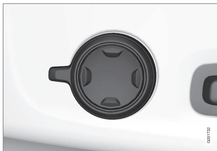
Multifunktionsreglaget, placerad på sidan av sätets sitt-del.
