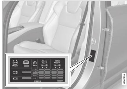
L'autocollant comporte la désignation des pneus montés en usine sur la voiture ainsi que les limites de charges et les pressions de gonflage.
