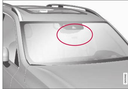
La zone indiquée ne doit pas être couverte (ni autocollant, ni filtre solaire, ni aucun autre objet, etc.)<sup>80</sup>.
