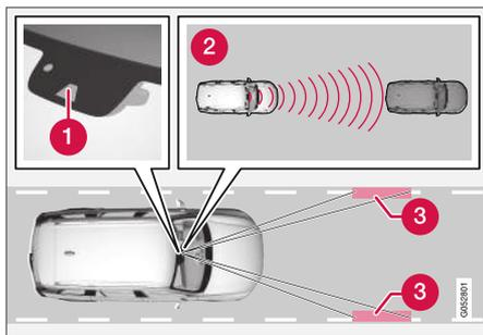
L'unité de caméra/radar mesure la distance au véhicule qui précède et détecte la signalisation au sol<sup>68</sup>.
