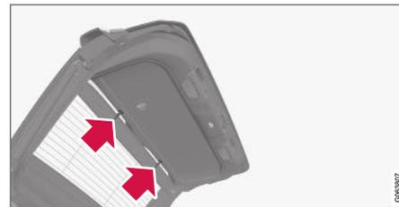
Enfoncez les deux attaches supérieures dans les encoches correspondantes du hayon afin de les fixer.
