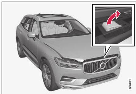
➔ Passez la main de la gauche vers la droite dans l'ouverture située sous le capot. Poussez la poignée vers le haut et sur le côté afin de libérer le capot du crochet de verrouillage puis soulevez le capot.
