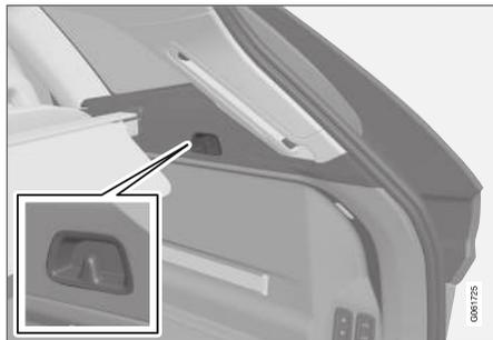
Les panneaux latéraux comportent également un crochet pour sacs à provisions (un de chaque côté du compartiment à bagages).
