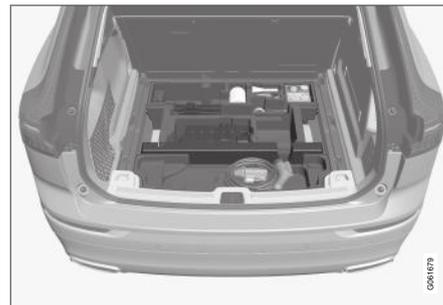
Le bloc de mousse sous la planche du compartiment à bagages renferme l'œillet de remorquage, le kit de réparation de crevaison, l'outil de dépose des capuchons en plastique des boulons de roue et la douille pour le boulon antivol.
