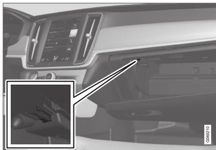
Logement prévu pour la clé. L'illustration est schématisique, l'apparence peut être différente.
