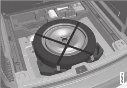
La roue de secours se trouve sous le plancher du compartiment de chargement et fixée par deux sangles. Le bloc de mousse renferme tous les outils nécessaires au remplacement des roues.
