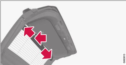
Retirez doucement le cache de l'un des fixations latérales du hayon puis de l'autre côté. Vous pouvez aussi appuyez légèrement sur le cache pour faciliter la dépose.
