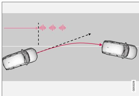
L'assistance de sortie de voie avertit le conducteur par des vibrations dans le volant<sup>116</sup>.
