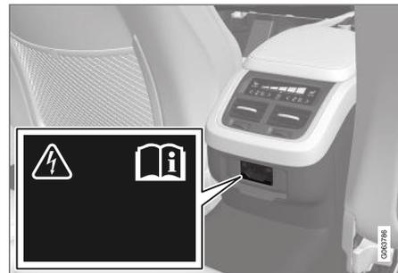
Prise électrique dans la console tunnel, banquette arrière.
