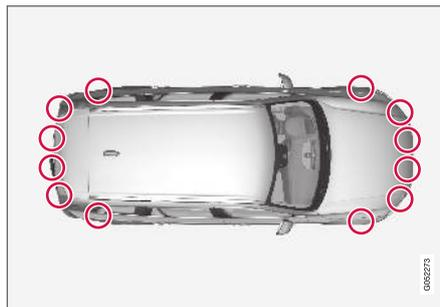
Emplacement des capteurs de stationnement<sup>124</sup>.
