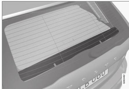
Un cache doit être monté sur le hayon lors de l'utilisation du cache-bagages.
