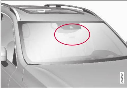
La zone indiquée ne doit pas être couverte (ni autocollant, ni filtre solaire, ni aucun autre objet, etc.)<sup>76</sup>.
