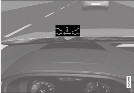
Symbole pour contrôle de la distance sur le pare-brise<sup>40</sup>.
