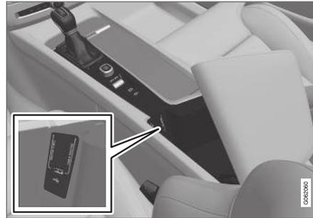
Prises USB (type A) de la console de tunnel. Vérifiez que le câble est en avant afin de ne pas le coincer en fermant la trappe.
