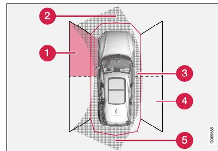
Secteurs des capteurs de stationnement où des obstacles peuvent être détectés<sup>131</sup>.
