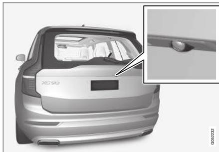
La caméra<sup>128</sup> arrière est placée au-dessus de la plaque d'immatriculation.
