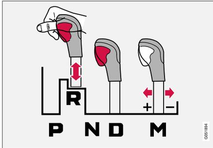
Il est possible de déplacer librement le levier de vitesses d'avant en arrière entre **N** et **D**. Les autres positions sont bloquées par un loquet commandé à l'aide du bouton de blocage du sélecteur de vitesses.
