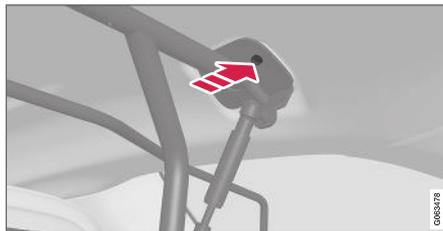
Montez la vis fournie et serrez, une clé de 6 mm est fournie. Répétez la procédure de l'autre côté. Couple de serrage recommandé : 20 Nm (15 pied-livre).
