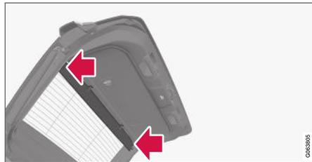
Orientez le cache correctement, avec la face comportant les vis vers le bas et insérez l'ergot dans la fixation sur un côté du hayon.
