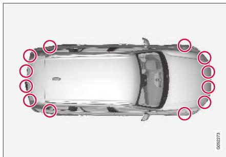
Emplacement des capteurs de stationnement<sup>138</sup>.
