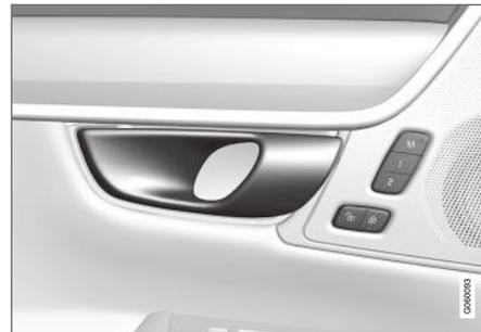
Poignée d'ouverture pour le déverrouillage alternatif d'une porte latérale<sup>16</sup>.
