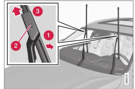
1. Relevez les bras d'essuie-glace lorsqu'ils sont en position d'entretien. La position d'entretien est activée/désactivée au moyen de la vue Fonctions de l'écran central lorsque la voiture est à l'arrêt et lorsque les essuie-glaces ne sont pas en marche.
