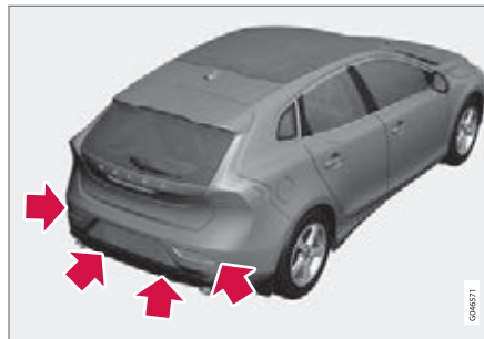
ตำแหน่งเซ็นเซอร์ด้านหลัง
