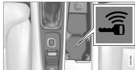
Tagavaraluger asub kesktunneli konsoolis.
