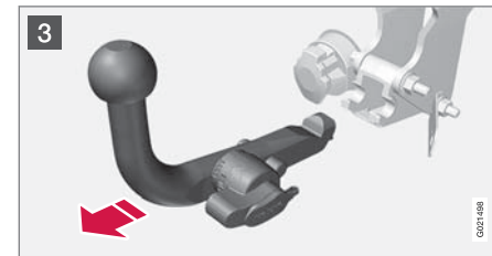
3 บิดปุ่มล็อกลงสุดจนหยุด จับไว้ในตำแหน่งนั้นในขณะที่ดึงส่วนลูกปืนข้อต่อไปข้างหลังและดึงขึ้น
