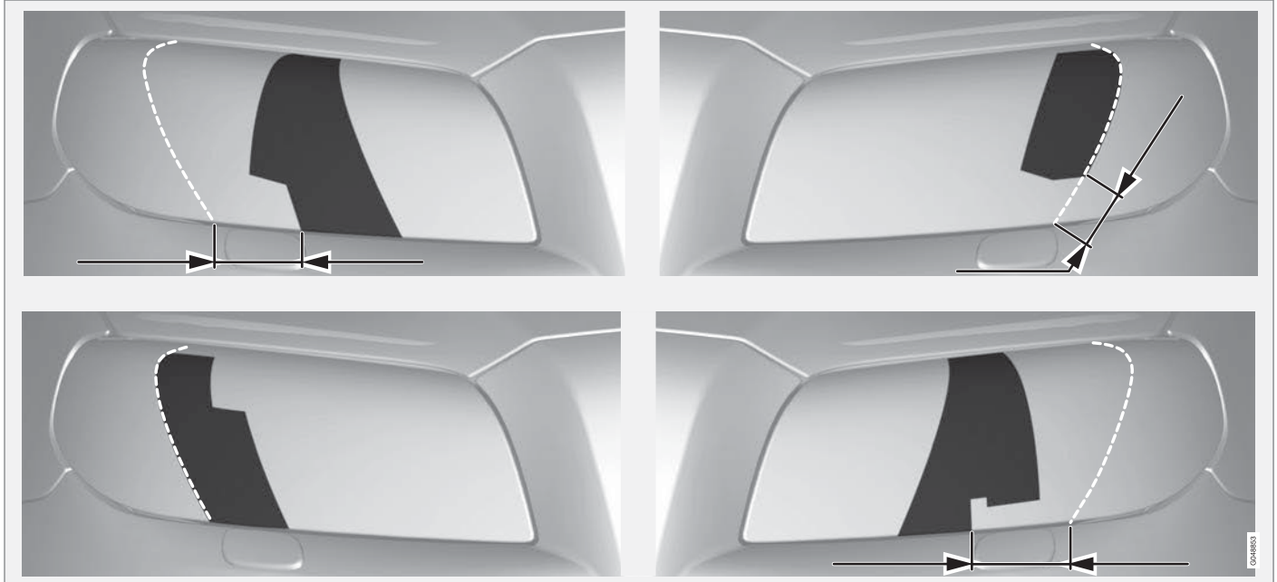
السهم العلوي: السيارات ذات عجلة القيادة اليسرى، القالبين A و B. السهم السفلي: السيارات ذات عجلة القيادة اليمنى، القالبين C و D.
