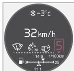
Sur le tableau de bord « Analogique », les positions de rapport et les flèches apparaissent au centre du combiné d'instruments.
