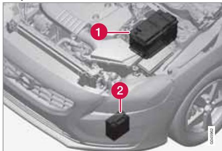
A : voiture à conduite à gauche. B : voiture à conduite à droite. 1. Batterie de démarrage<sup>3</sup>. 2. Batterie d'appoint.
