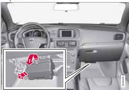
1. Tirez sur le cache en vous aidant de l'encoche jusqu'à ce que les pattes de verrouillage du bord inférieur du cache se détachent.
