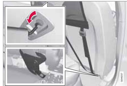
4. Accrochez la sangle du filet dans les œillets arrière des glissières des sièges. Pour faciliter l'opération, mettez les dossiers bien droit et avancez légèrement les sièges.
