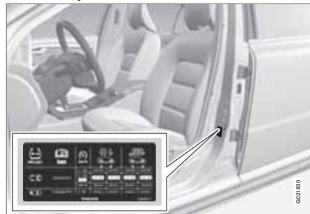
L'autocollant de pressions de pneu sur l'intérieur du montant de porte du côté conducteur (entre les portes avant et arrière) quelle pression les pneus doivent avoir à différentes conditions de charge et de vitesse. La pression correcte est aussi indiquée dans le tableau de pressions de pneu, voir page 403.
