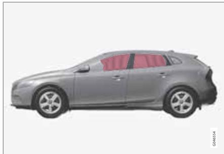
Le rideau gonflable IC (Inflatable Curtain) fait partie des systèmes de coussins gonflables et SIPS. Le rideau gonflable est dissimulé dans la garniture de plafond des deux côtés de la voiture et il protège les occupants des places extérieures. Lors d'une forte collision, les capteurs réagissent et le rideau gonflable se gonfle. Le rideau gonflable a été conçu pour empêcher la tête du conducteur et des passagers de heurter l'intérieur de la voiture en cas de collision.
