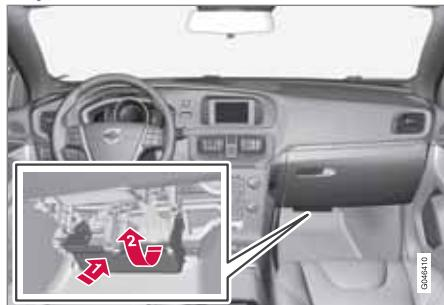
1. Insérez les talons inférieurs de blocage.
