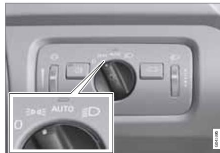
Commutateur d'éclairage en position de feux de position/de stationnement.
