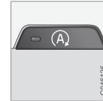
La fonction Start/Stop est automatiquement activée lors du démarrage du moteur. Le conducteur est informé que la fonction est active grâce à ce symbole allumé sur le tableau de bord, au message **Dém./**
