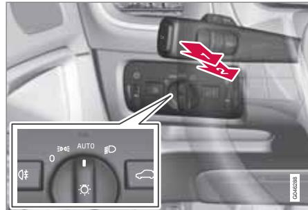
Commutateur d'éclairage et levier au volant.
