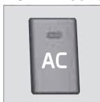
Lorsque le témoin du bouton **AC** est allumé, la climatisation est commandée automatiquement par le système. Dans ce cas, l'air entrant est refroidi et déshumidifié au besoin.
