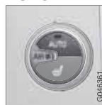
Cette fonction automatique régule automatiquement la température, l'air conditionné, la vitesse du ventilateur, la recirculation et la répartition de l'air.
