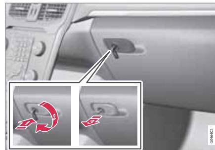
La boîte à gants ne peut être verrouillée/déverrouillée qu'à l'aide de la lame de clé de la télécommande. Pour de plus amples informations sur la lame de clé, voir page 51.
