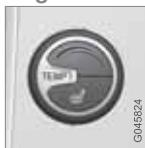
Le bouton de réglage permet de régler la température de l'habitacle.
