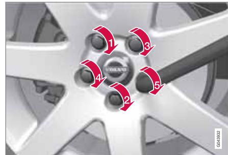
4. Serrez fermement les boulons de roue en croix et de manière alternée. Il est important que les boulons de roue soient correctement serrés (voir page 335 pour le couple de serrage). Vérifiez le couple de serrage des écrous à l'aide d'une clé dynamométrique.
