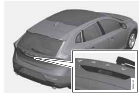
Bouton gainé de caoutchouc avec contact électrique.
