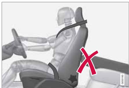
*Ne placez jamais d'objets sur la banquette arrière qui pourraient gêner le fonctionnement du système WHIPS.*
