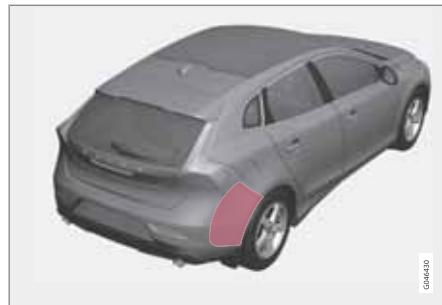
Placement du capteur BLIS et CTA.
