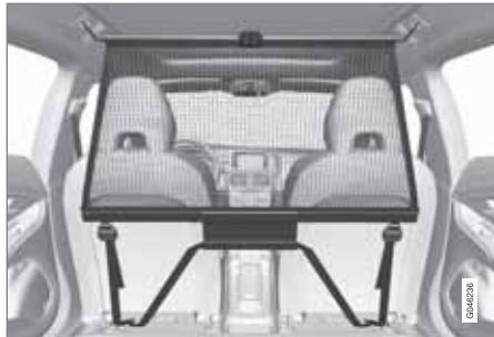
*Le filet de chargement se monte sur quatre points de fixation.*
