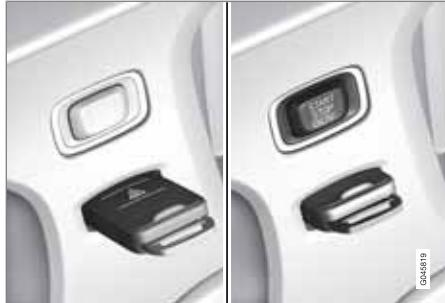
Contacteur d'allumage avec télécommande retirée/insérée.
