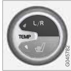
La température peut être réglée séparément du côté conducteur et du côté passager. Appuyez plusieurs fois sur le bouton **L/R** pour sélectionner le côté gauche, le côté droit ou les deux. Réglez la température avec le bouton de réglage. La température sélectionnée de chaque côté est affichée sur l'écran de la console centrale.
