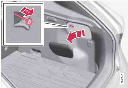
La trappe de réservoir peut être ouverte à la main lorsqu'il n'est pas possible de l'ouvrir de l'intérieur.
