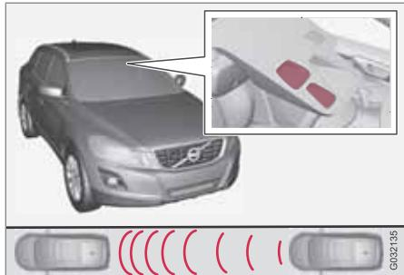
Fenêtre d'émission et de réception du capteur laser<sup>1</sup>.
