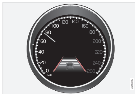
Marquage au sol de la fonction LDW (en rouge sur l'illustration).
