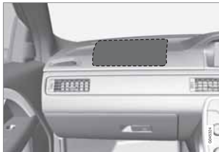
Placering av krockkudde på passagerarsidan i högerstyrd bil.
