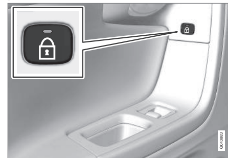
Le témoin lumineux dans le bouton est allumé lorsque la portière est verrouillée
