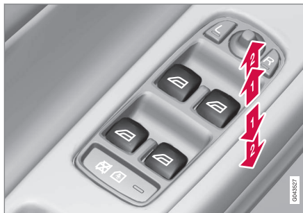
Fonctionnement des vitres électriques
