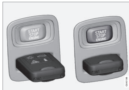
Contacteur d'allumage avec télécommande retirée/insérée.
