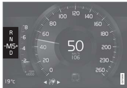
מחווך החלפת הילוכים בצג נהג 8 אינץ' עבור ידית בורר הילוכים קטנה.
