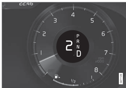
צג הנהג בזמן החלפת הילוך באמצעות ידיות גלגל ההגה, ידית בורר הילוכים גדולה.
