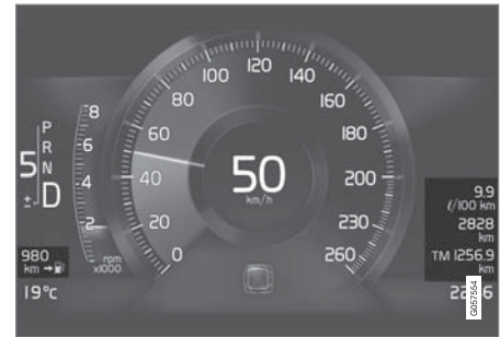
דוגמאות למידע מחשב הנסיעה בצג הנהג 8 אינץ'. האזור הוא סכמטי - הלקים ממנו עשויים להיות שונים בהתאם לדגם המכונית.
