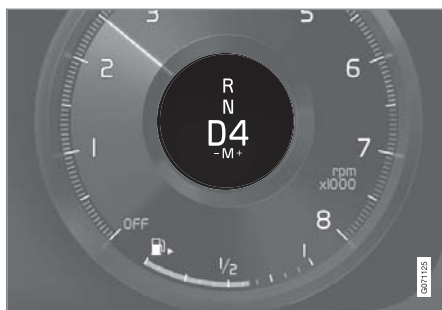
צג הנהג בזמן החלפת הילוך באמצעות ידיות גלגל ההגה, ידית בורר הילוכים קטנה.
