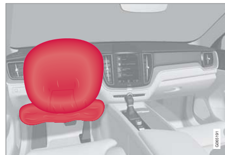
כרית אוויר בגלגל ההגה וכרית אוויר לברכיים 1 בצד הנהג במושב הקדמי.
