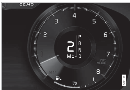
צג הנהג בזמן החלפת הילוך באמצעות ידיות גלגל ההגה במצב החלפת הילוכים ידנית, ידית בורר הילוכים גדולה.
