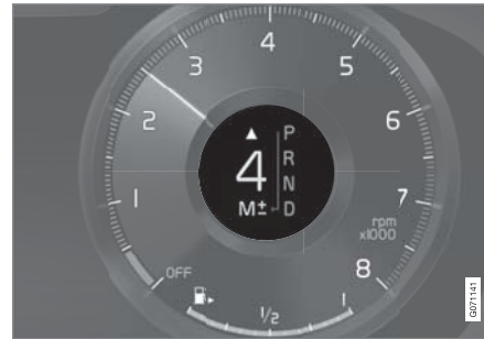
מחווון החלפת הילוכים בצג נהג 12 אינץ' עבור ידית בורר הילוכים גדולה*.
