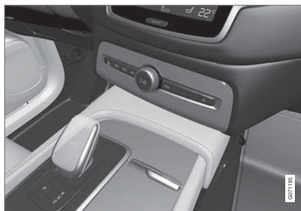
סקירה של ידית ההילוכים קטנה במקרה שלא ניתן להשבית את פעולת מונע שילוב בורר ההילוכים.
