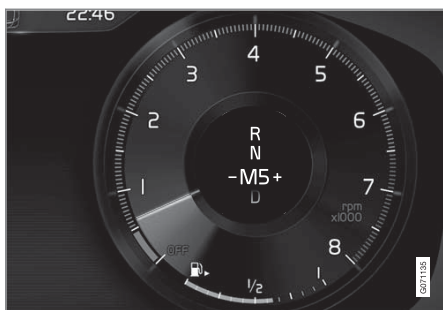
צג הנהג בזמן החלפת הילוך באמצעות ידיות גלגל ההגה במצב החלפת הילוכים ידנית, ידית בורר הילוכים קטנה.
