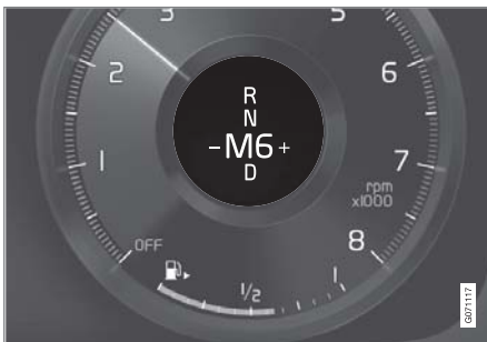
מחווון החלפת הילוכים בצג נהג 12 אינץ' עבור ידית בורר הילוכים קטנה*.
