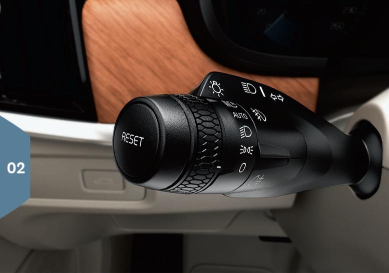
**Éclairage de sécurité d'accueil** allume les phares, les feux de stationnement et l'éclairage de poignée de porte\* pour éclairer la zone à l'avant du véhicule dans l'obscurité. Pour activer cette fonction, couper le contact et pousser le levier vers la planche de bord aussi loin que possible puis le relâcher. L'éclairage s'éteint automatiquement après un certain temps.
