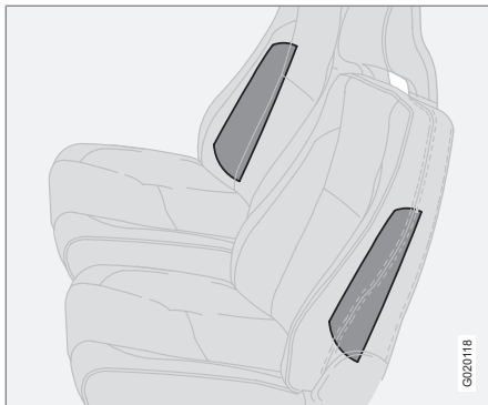
Colocación de airbags laterales.
