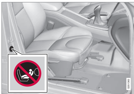
2. variant: kaassõitja turvapadja silt uksepilariil. Turvapadja silt on nähtav juhi kõrvalistuja ukse avamisel.
