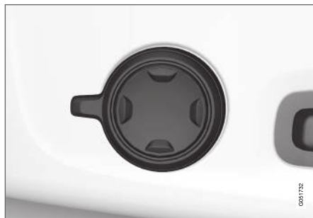
Multifunktionsreglaget, placerad på sidan av sätets sitt-del.
