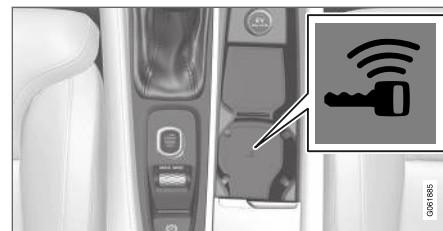
Backup-läsarens placering i tunnelkonsolen.
