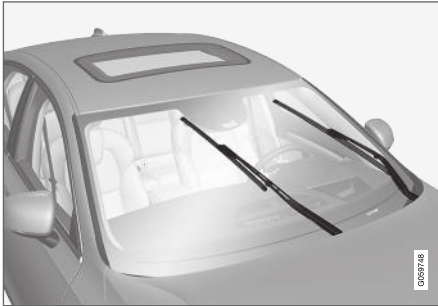
Torkarblad i serviceläge.
