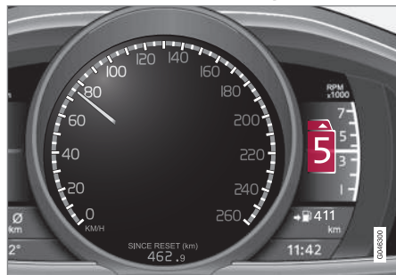
Combiné d'instruments numérique avec indicateur de rapport.
