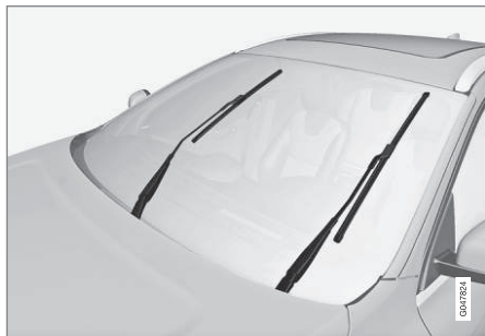
Balais d'essuie-glace en position d'entretien.
