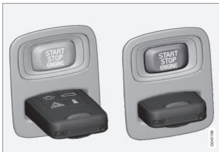
Contacteur d'allumage avec télécommande retirée/insérée.
