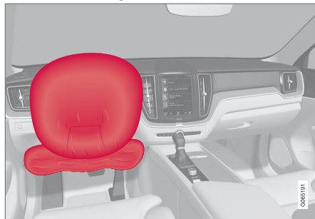
Airbag ve volantu a kolenní airbag 1 na straně řidiče a jeho kolena a nohy před poraněním.
