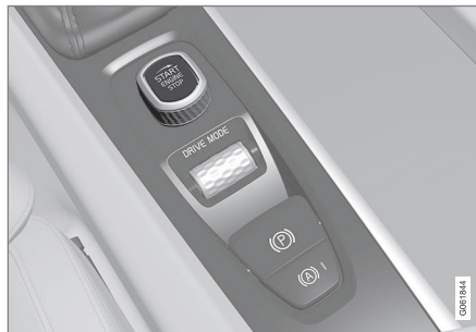
Startovací knoflík na tunelové konzole.
