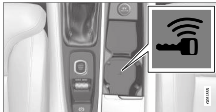
Umístění záložní čtečky v tunelové konzole.
