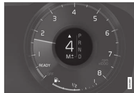
Indikátor řazení převodových stupňů na 12" displeji řidiče*.
