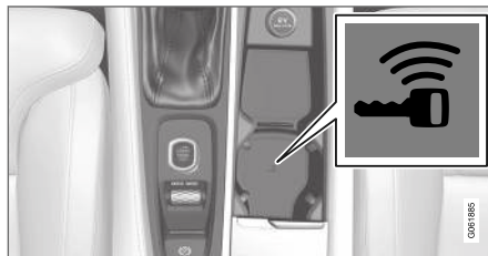
Varmistuselukijan sijainti tunnelikonsolissa.
