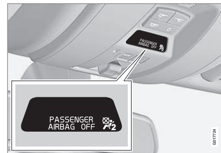
Indikering som visar att passagerarplatsens krockkudde är deaktiverad.
