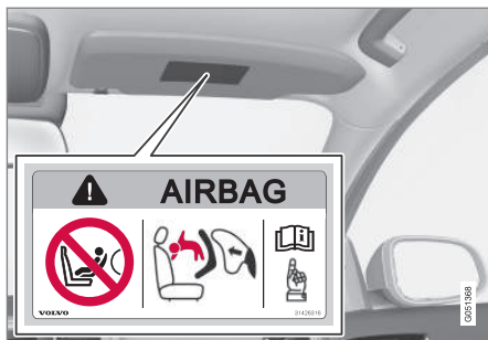
Alternativ 1: Placering av krockkuddens dekal på passagerarsidans solskydd.
