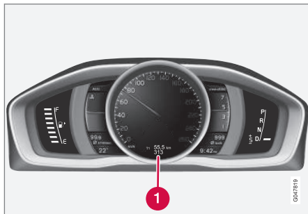
Dagteller, digitaal instrument.
