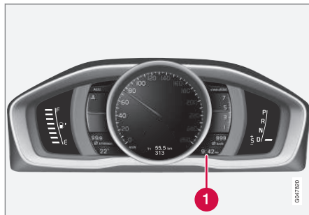
Klok, digitaal instrument.
