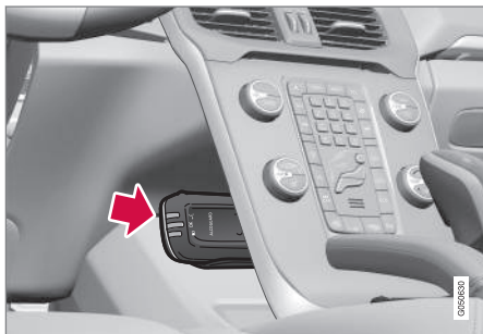
Handenhetens förvaring och laddstation.
