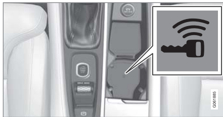
備用讀取器位於中央扶手控制台中。
