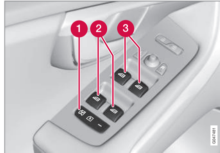
Säädinpaneeli kuljettajan ovessa.
