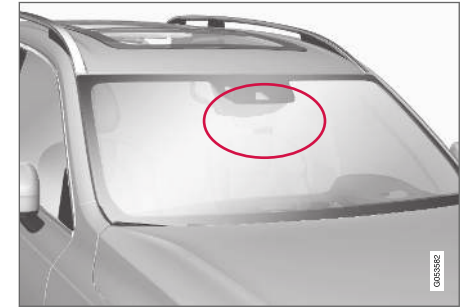
Emplacement du capteur radar.
