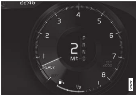
Écran du conducteur lors d'un changement de rapport à l'aide des palettes au volant en mode de changement de rapports manuel.
