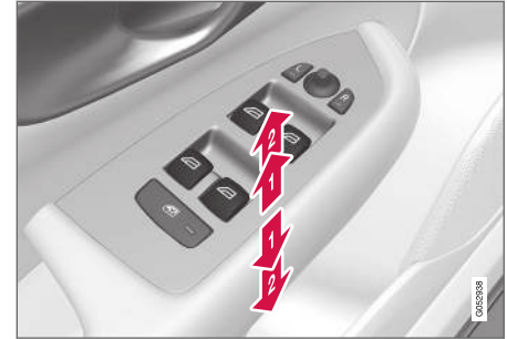
Fonctionnement des vitres électriques.
