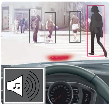
Vozidlo je vybaveno systémem varování před kolizí s automatickou aktivací brzd a detekcí chodců. Tento systém dokáže v případě vozidel, cyklistů a chodců varovat, přibrzdit resp. zastavit.
