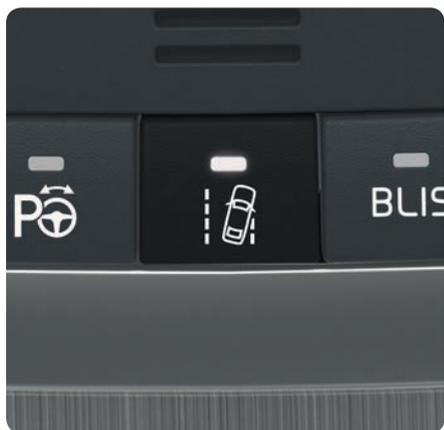
Pokud chcete přejet přes boční čáru, systém LKA vyvine jistý moment na volant a bude aktivně řídit zpět do pruhu. Pokud vozidlo přejede boční čáru, systém LKA vás upozorní pulzujícími vibracemi ve volantu.
