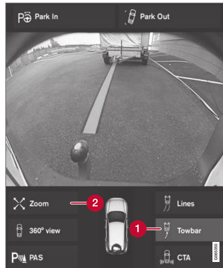
Vilkšanas iekārta ar novietošanas palīglīniju 129 .
