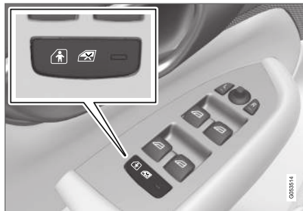
Elektriskās aktivizēšanas un deaktivizēšanas taustiņš.
