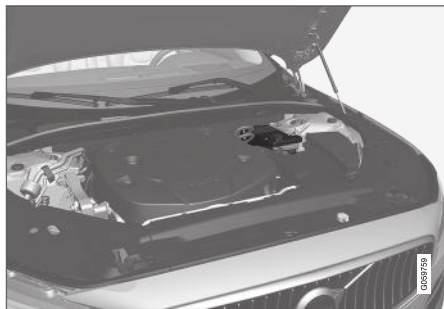
Atbalsta akumulators atrodas kastē blakus statnim.
