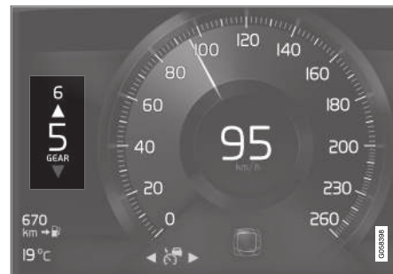
Pārnesumu pārlēgšanas indikators 8 collu vadītāja displejā.
