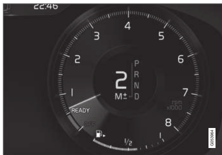
Manuālas pārnesumu pārslēgšanas režīms vadītāja displejā 3 .
