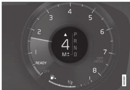
Pārnesumu pārlēgšanas indikators 12 collu vadītāja displejā*.
