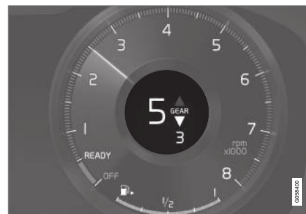
Pārnesumu pārlēgšanas indikators 12 collu vadītāja displejā*.
