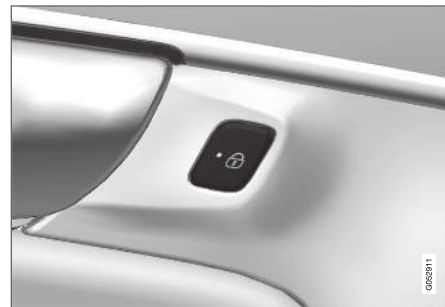
Záró gomb visszajelző lámpával a hátsó ajtóban.
