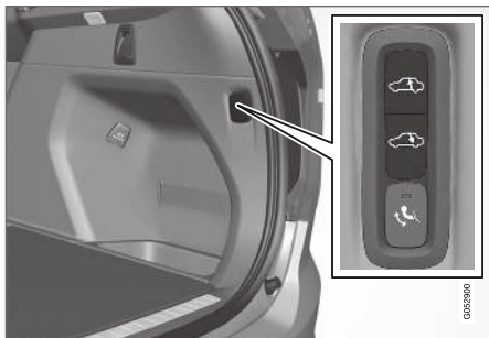
Az autó hátsó részét emelő/süllyesztő kezelőszervek
