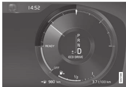
Eco műszer a 12-hüvelykes járművezetői kijelzőn*.
