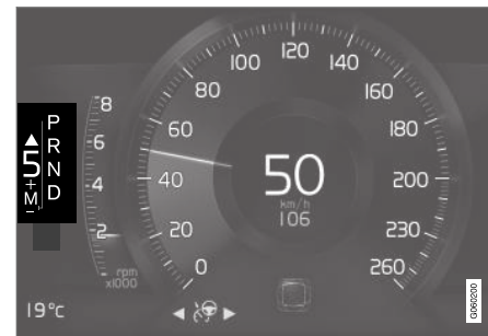
Fokozatváltás-jelző a 8-hüvelyes járművezetői kijelzőn.
