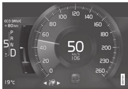
Eco műszer a 8-hüvelykes járművezetői kijelzőn.
