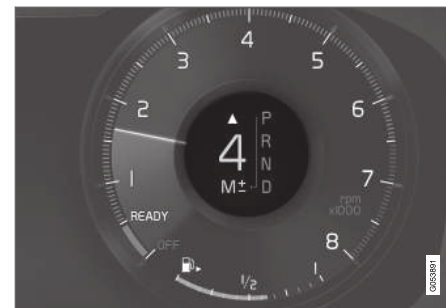
Fokozatváltás-jelző a 12-hüvelyes járművezetői kijelzőn*.
