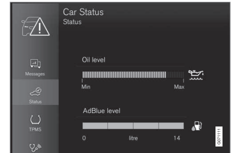
Gráfico del nivel de aceite en la pantalla central.
