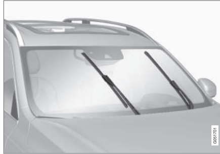
Escobillas de limpiaparabrisas en posición de servicio.
