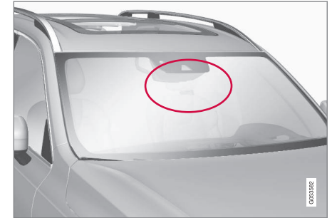
Ubicación de la unidad de radar.
