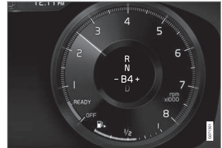
Pantalla del conductor al cambiar de marcha con las levas del volante en la posición de cambio manual.
