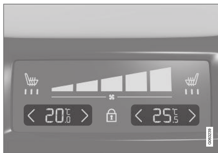
Tunnelkonsooli tagaosa kliimapaneeil olev temperatuuri regulaator.
