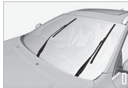
Torkarblad i serviceläge.
