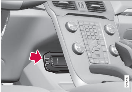
Handenhetens förvaring och laddstation.
