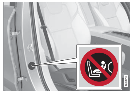
รูปลอกจะอยู่บนเสาประตูด้านผู้โดยสาร ป้ายสำหรับถุงลมนิรภัยจะสามารถมองเห็นได้เมื่อเปิดประตูผู้โดยสาร
