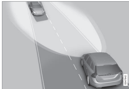
Funzionalità adattiva: Anabbaglianti direttamente contro il veicolo sopraggiungente nel verso di marcia opposto, ma abbaglianti ancora attivi su entrambi i lati di esso.
