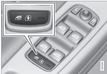
Panel de comando da porta do condutor.
