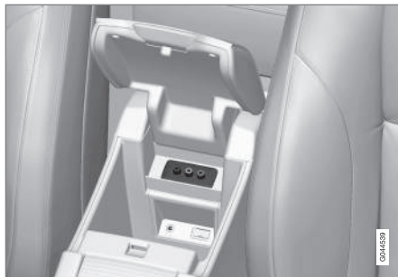
Η υποδοχή A/V-AUX In βρίσκεται κάτω από το υποβραχιόνιο στην επιμήκη κονσόλα.
