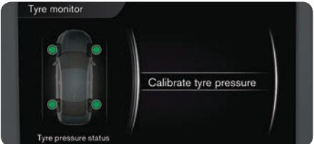
Po výměně pneumatik nebo změně tlaku vzduchu v pneumatikách je vždy zapotřebí kalibrace. Pokud se rozsvítí kontrolka , systém se musí nakalibrovat. Postupujte následovně:
