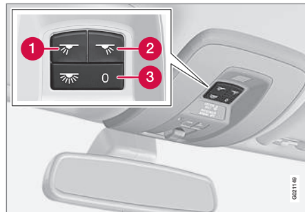
Interrupteurs d'éclairage, éclairage de pavillon avant
