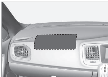
Plassering kollisjonspute på passasjersiden i bil med høyerrett.
