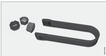
เครื่องมือสำหรับการถอดฝาปิดพลาสติกบนโบลท์ล้อ
