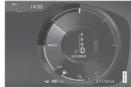
เกจวัด Eco บนจอแสดงผลสำหรับคนขับขนาด 12 นิ้ว
