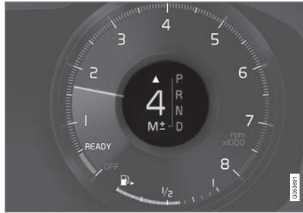
ไฟแสดงการเปลี่ยนเกียร์บนจอแสดงผลสำหรับคนขับขนาด 12 นิ้ว
