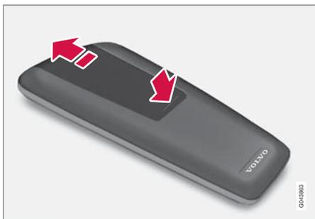
1. 電池カバーのキャッチを押し、赤外線レンズの方向に電池カバーをスライドさせます。
