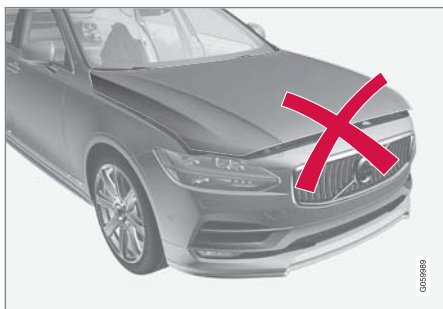
引擎蓋並未完全關閉。
