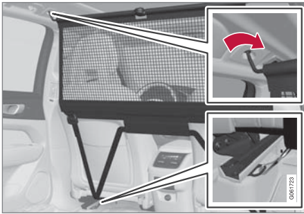
前段安裝位置。
