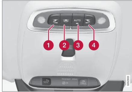
車頂控制台內用於前閱讀燈與乘客室照明的控制裝置。
